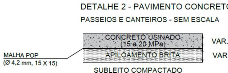
Figura 12 - Pavimento Concreto Usinado Calçada de 5 cm.
